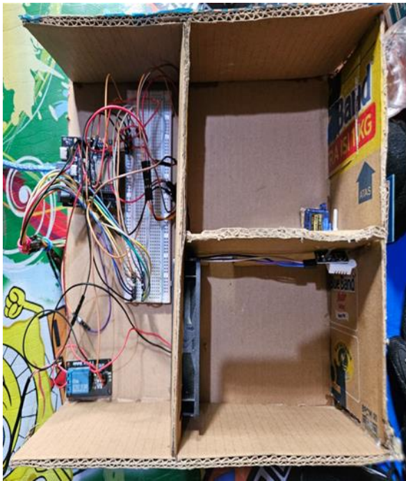
Gambar 5. Desain prototipe rumah pintar dengan komponen utama sistem kendali suhu berbasis IoT
